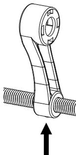
3. La vis pointeau sous la butée permet le réglage de cette dernière, son empreinte ne doit pas être recouverte de peinture.
