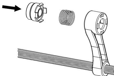
2. Le tampon se clipse et emprisonne le ressort en permettant d'assurer la fonction amortisseur après assemblage.
