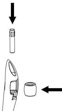
1. L'axe de la roulette doit se monter serré à l'aide d'un maillet (*attention au sens de l'axe*). L'axe doit maintenir la roulette en position tout en permettant la rotation de celle-ci.
